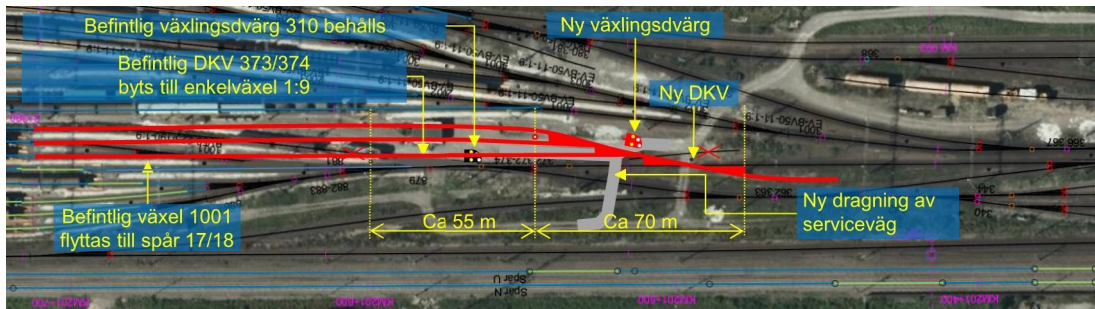
Figur 52: Förlängning av spår 16, 17 & 18.
