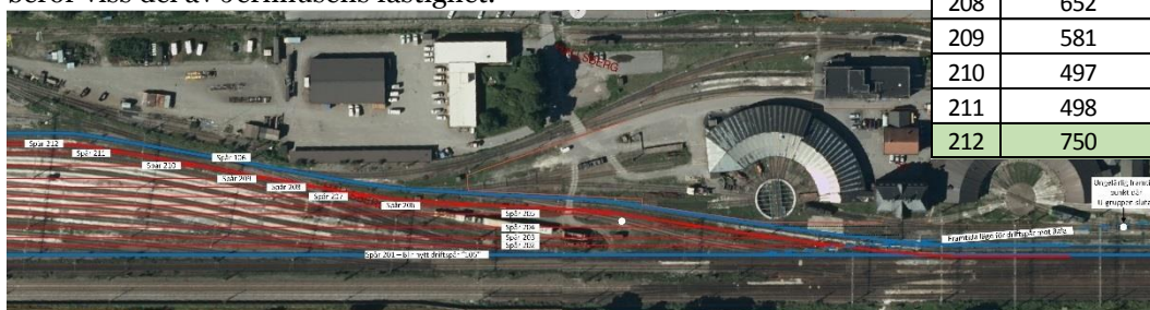
Figur 55: Spår 202-211 läggs om och ansluter mot spår 212. Spår 201 blir passagespår.
